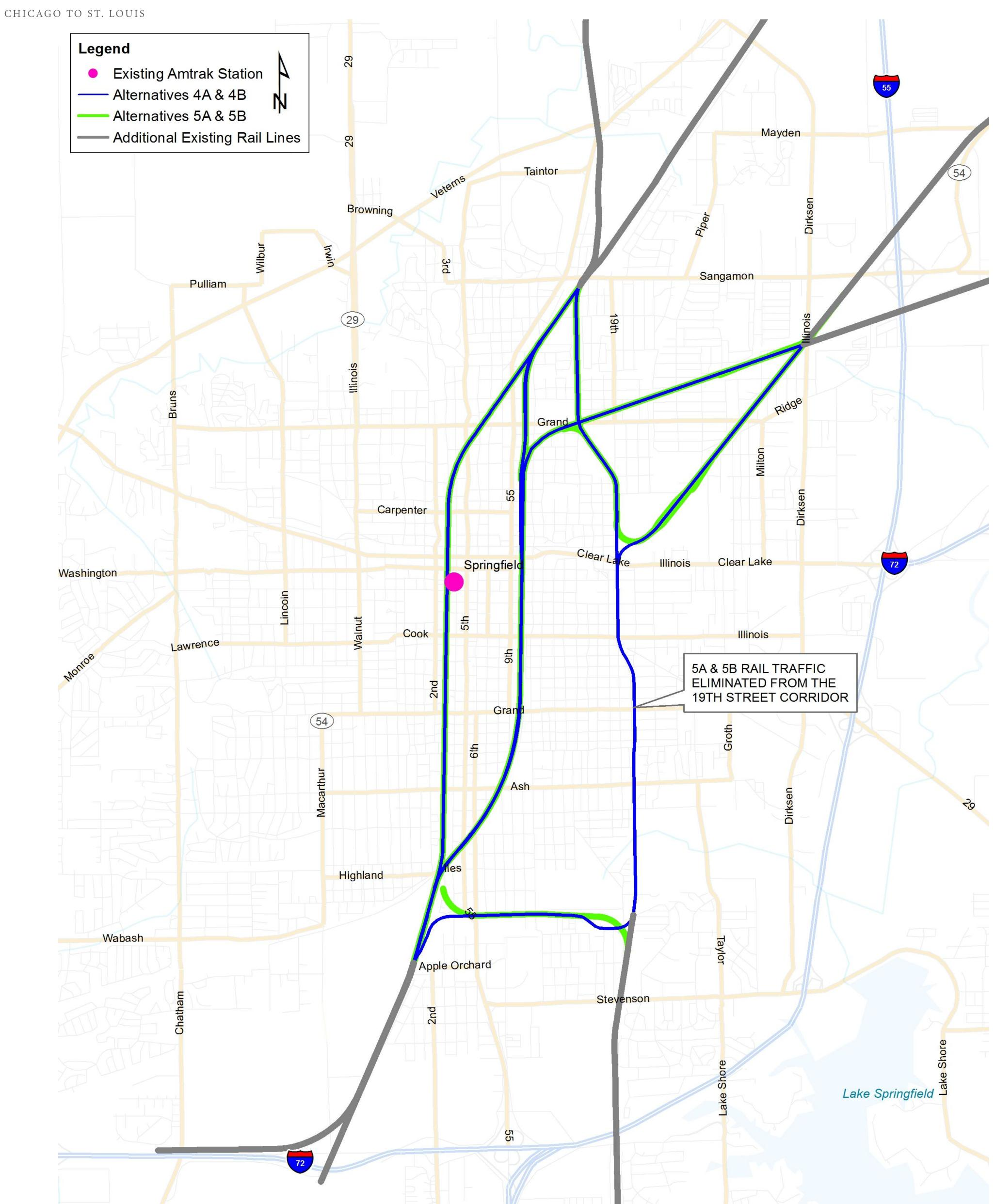
PASSENGER RAIL TRAFFIC REMAINS ON 3<sup>RD</sup> STREET FOR 4A, 4B, 5A, AND 5B 4A & 4B – 3<sup>RD</sup> STREET FREIGHT RAIL TRAFFIC SHIFTED TO 10<sup>TH</sup> STREET 5A & 5B – 3<sup>RD</sup> AND 19<sup>TH</sup> STREET FREIGHT RAIL TRAFFIC SHIFTED TO 10<sup>TH</sup> STREET ALTERNATIVES 4B & 5B HAVE ADDITIONAL GRADE SEPARATIONS
